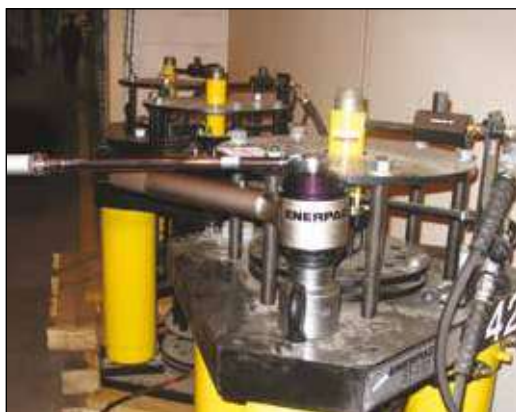
◀ Мультиплікатор Енерпас Е393 з опорною штангою використовується для ручного закручування болтів із моментом до 4300 Нм.
