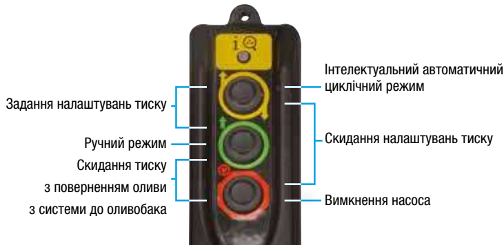
Пульт керування з 6-метровим дротом
