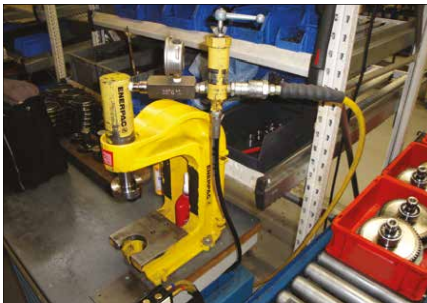
▲ Циліндр RC-308 в оправному пресі А-330 із приводом від пневматичного насоса PATG-Turbo для контрольованого випресування та запресування підшипників ткацьких верстатів. Запобіжний клапан V-152 обмежує зусилля преса.
