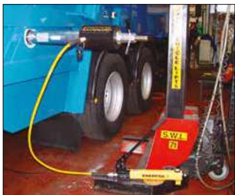
◀ RACH-306 із ручним насосом P-392 використовується для вилучення закородованих вісей зі сміттєзбиральної машини.
