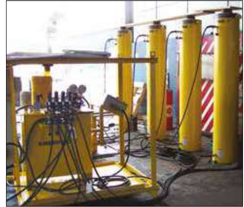
▲ Замовні циліндри двобічної дії вантажопідйомністю 500 тонн із робочим ходом 1,83 м для піднімання електричних канатних екскаваторів.
