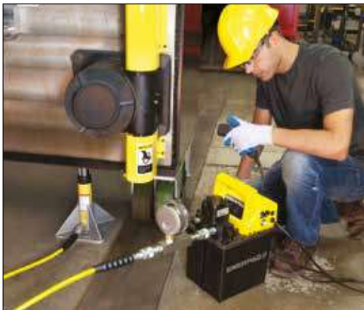
◀ Насос серії PEJ із занурювальним двигуном і пультом дистанційного керування полегшує технічне обслуговування машини.
