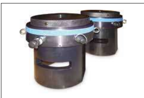
◀ Спеціалізовані гідравлічні натягувачі для роботи зі шпильками на 5 дюймів, створюване зусилля - 4200 кН.
