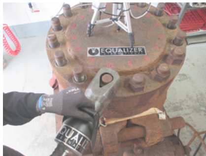
Гайкоріз Equalize NS36TE зрізає іржаві гайки
