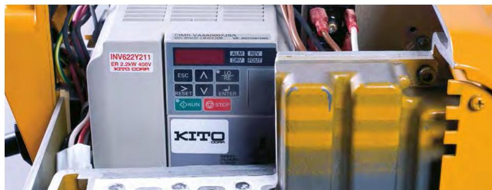
**Счетчик рабочих часов / грузоподъемных циклов встроенный в инвертор**
